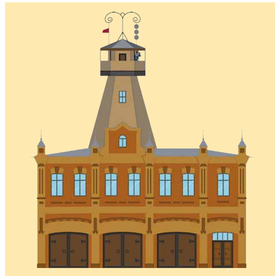
Фасад пожарного депо на ул. Негорелой г. Иваново-Вознесенска после перестройки 1913 г. Реконструкция. Здание было надстроено вторым этажом — для обеспечения жильем пожарных служителей и брандмейстера. Над зданием части была устроена первая в городе пожарная каланча (постройка была деревянной).
